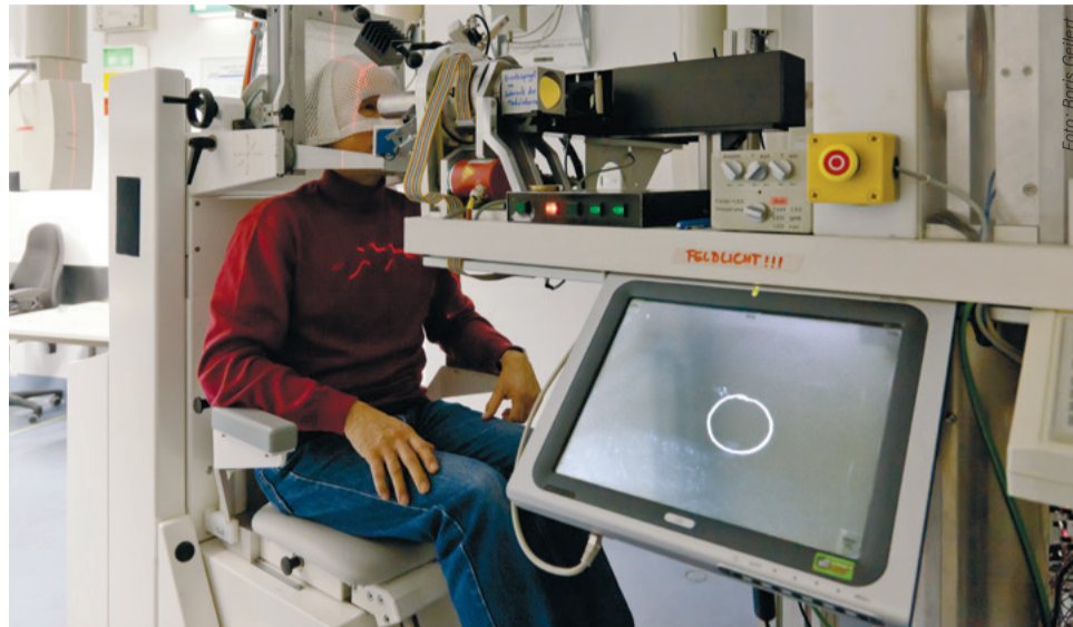
Blick in den Behandlungsraum am Standort Wannsee: Der Patient (hier ein Beispielbild) wird mit Maske und Bißblock fixiert, damit der Protonenstrahl nur das Tumorgewebe zerstört.
