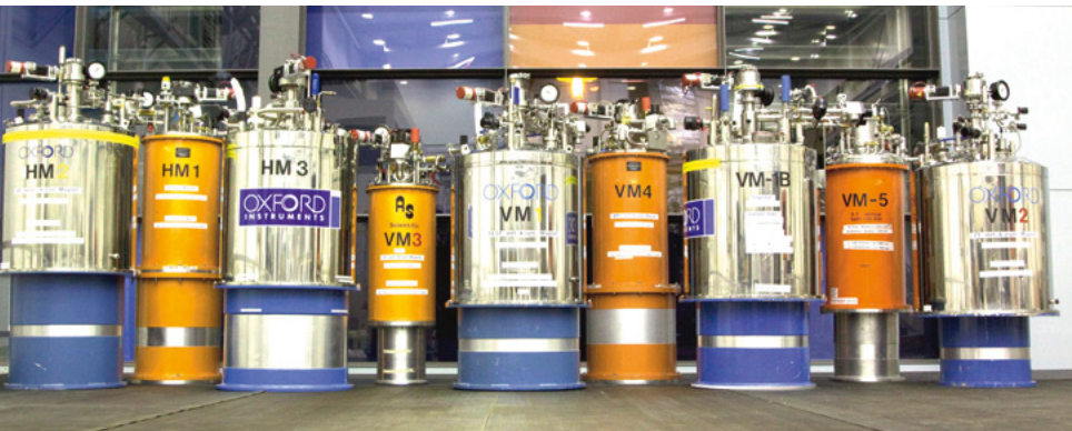
Die Kryomagnete der Abteilung Probenumgebung am HZB. Sie konnten auf vielen Instrumenten am BER II eingesetzt werden und erlaubten Experimente mit hohen Magnetfeldern. Die Magnete VM-1 und VM-1B stellten lange Zeit die weltweit höchsten statischen Magnetfelder für Neutronenstreuung.
